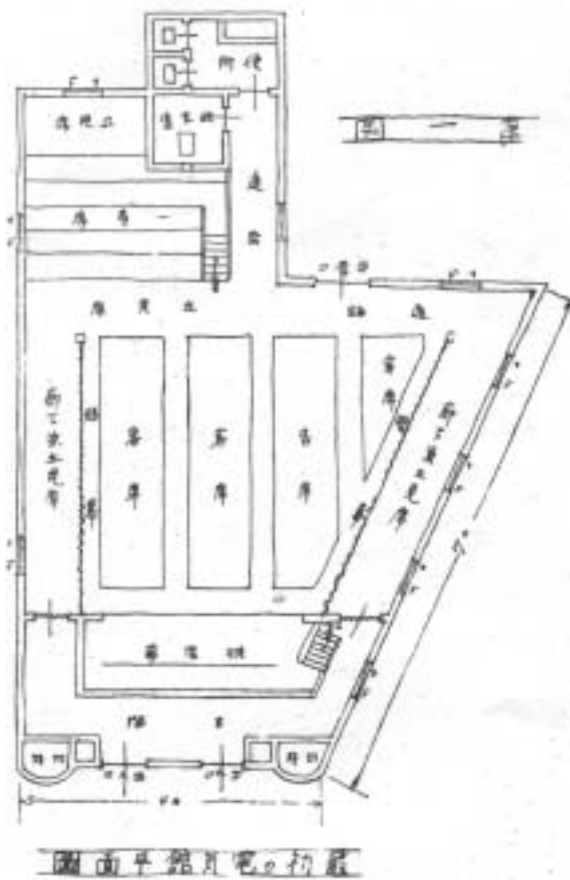
図1：加藤秋「我国に於ける活動写真館の建築沿革」『建築新潮』6-1、1925年1月、16頁。 なお、図の下部にみられる半円形の切符売場は、ニッケルオデオンの特色としても知られている (Douglas Gomery, Shared Pleasure: A History of Movie Presentation in the United States , Madison: The University of Wisconsin Press, 1992, p.19)。ただし、一般的に出入口中央に位置するニッケルオデオンの切符売場とは、配置が異なる。
