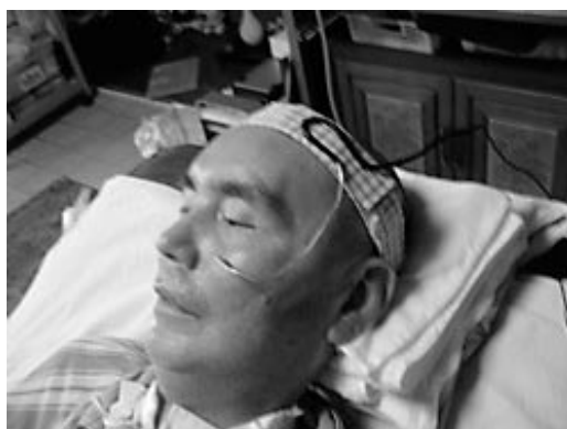
図4 和中が現在使用しているセンサー式入力インタフェース
